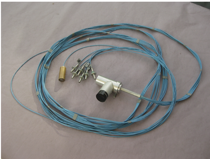
Abb 3.: LWL-Kabel (Faserende in der Messinghülse zur Ankopplung an den Spektrographen, 6 einzelne Faserenden zur Nachführung,)
