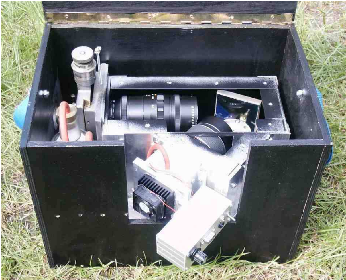
Abb. 4: Spektrograph mit geöffnetem Gehäuse
